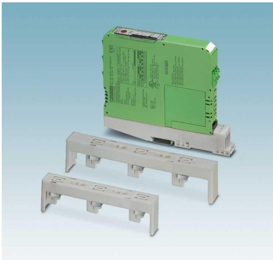
Эти устойчивые к короткому замыканию 3-фазные гибридные пускатели для монтажной рейки 30 мм или токовой магистрали 60 мм объединяют в себе 4 функции: право- и левостороннего контактора, реле защиты двигателя и устройства аварийного останова до категории 3.
