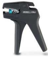
Сечение провода 0,08 - 2,5 мм 2
