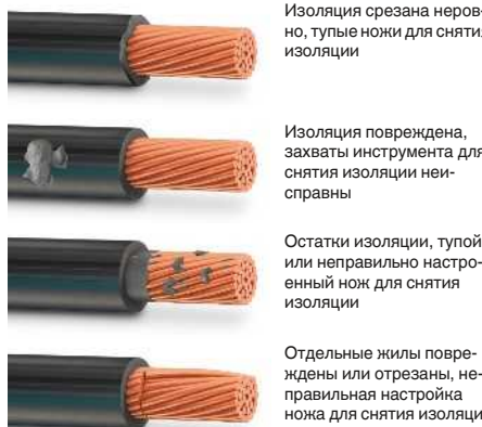
Ошибки снятия изоляции по DIN МЭК 60352
