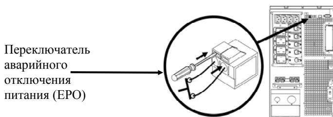
Как схемы Класса 2, так и схемы SELV должны быть изолированы от всех первичных цепей. Не подключайте другие цепи к контактной колодке переключателя EPO, если они не являются схемами класса 2 или схемами SELV.
