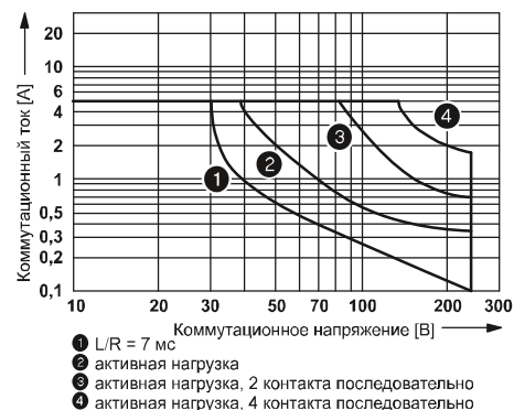
Мощность отключения постоянного напряжения
